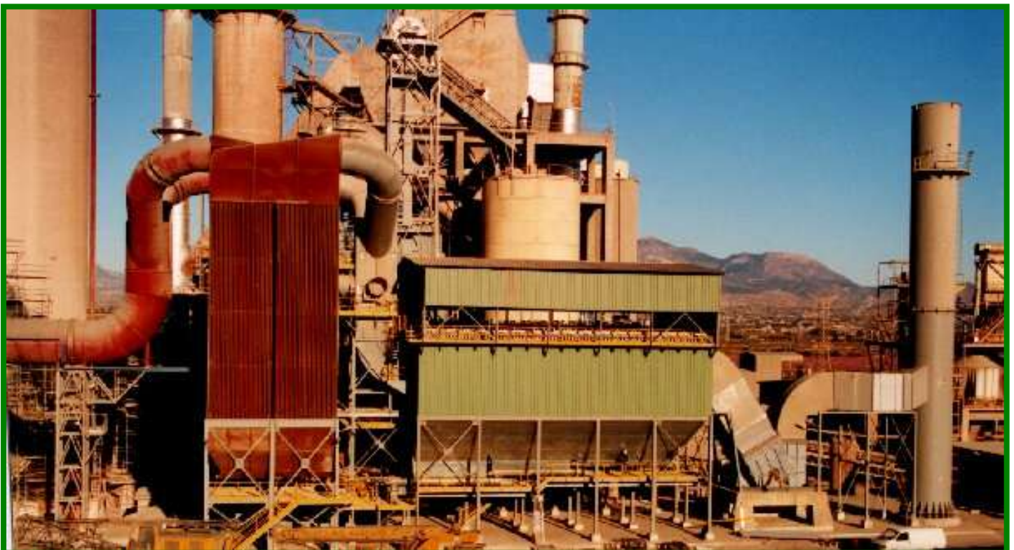
цементная печь, 400.000 куб.м/ч, охладитель и фильтр ООО «ТИ-СИСТЕМС» ИНЖИНИРИНГ И ПОСТАВКА ТЕХНОЛОГИЧЕСКОГО ОБОРУДОВАНИЯ Интернет: www.tisys.ru www.tisys.kz www.tisys.by www.tesec.ru www.ти-системс.рф Телефоны для связи: +7 (495) 7774788, 7489626, 5007154, 55, 65 Эл. почта: info@tisys.ru
